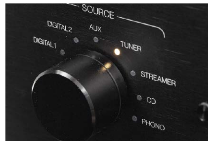
Przełącznik wejść jest sterowany mikroprocesorowo, wskaźniki diodowe informują również o aktywacji systemu zabezpieczeń.
